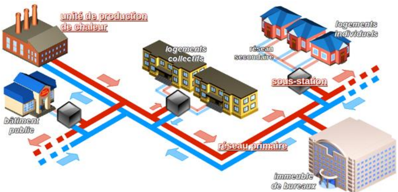
Figure 7. Schéma d'un réseau de chaleur. Source : ADEME
