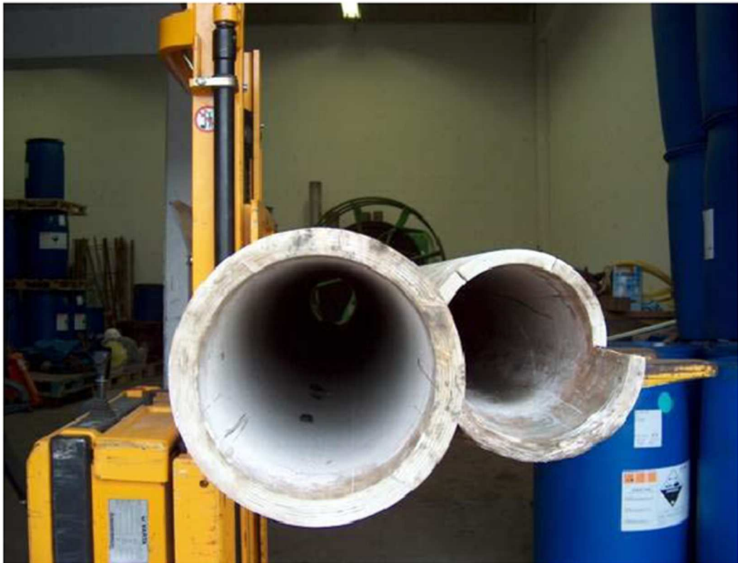
Figure 34 : Tubes (9 5/8 ) en matériaux composites remontés au jour après 13 ans de service (puits de production GLCS1 de La Courneuve Sud) (source : GPC IP).
